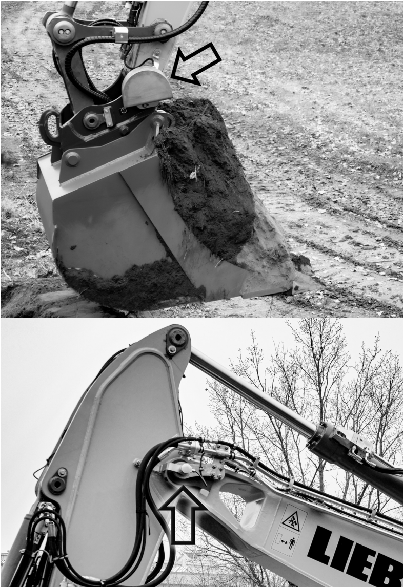
44 Abb. 4: Vom Hersteller auf Anfrage nachgerüstete Gelenkwinkelsensorik für die Autonomiefunktionen. (Quelle: Fraunhofer IOSB)
